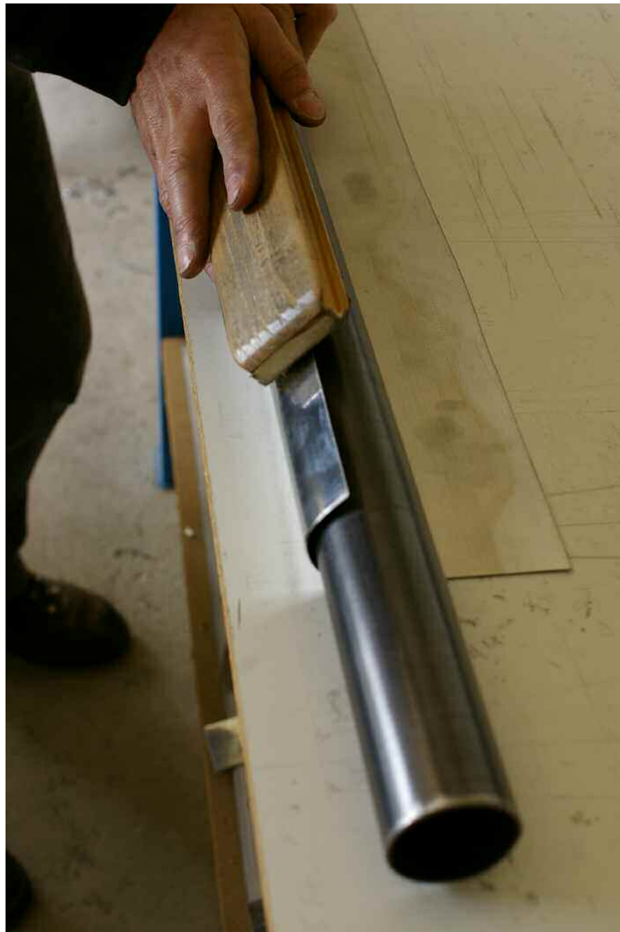
MISE EN FORME DU CORPS AVEC LE MANDRIN
