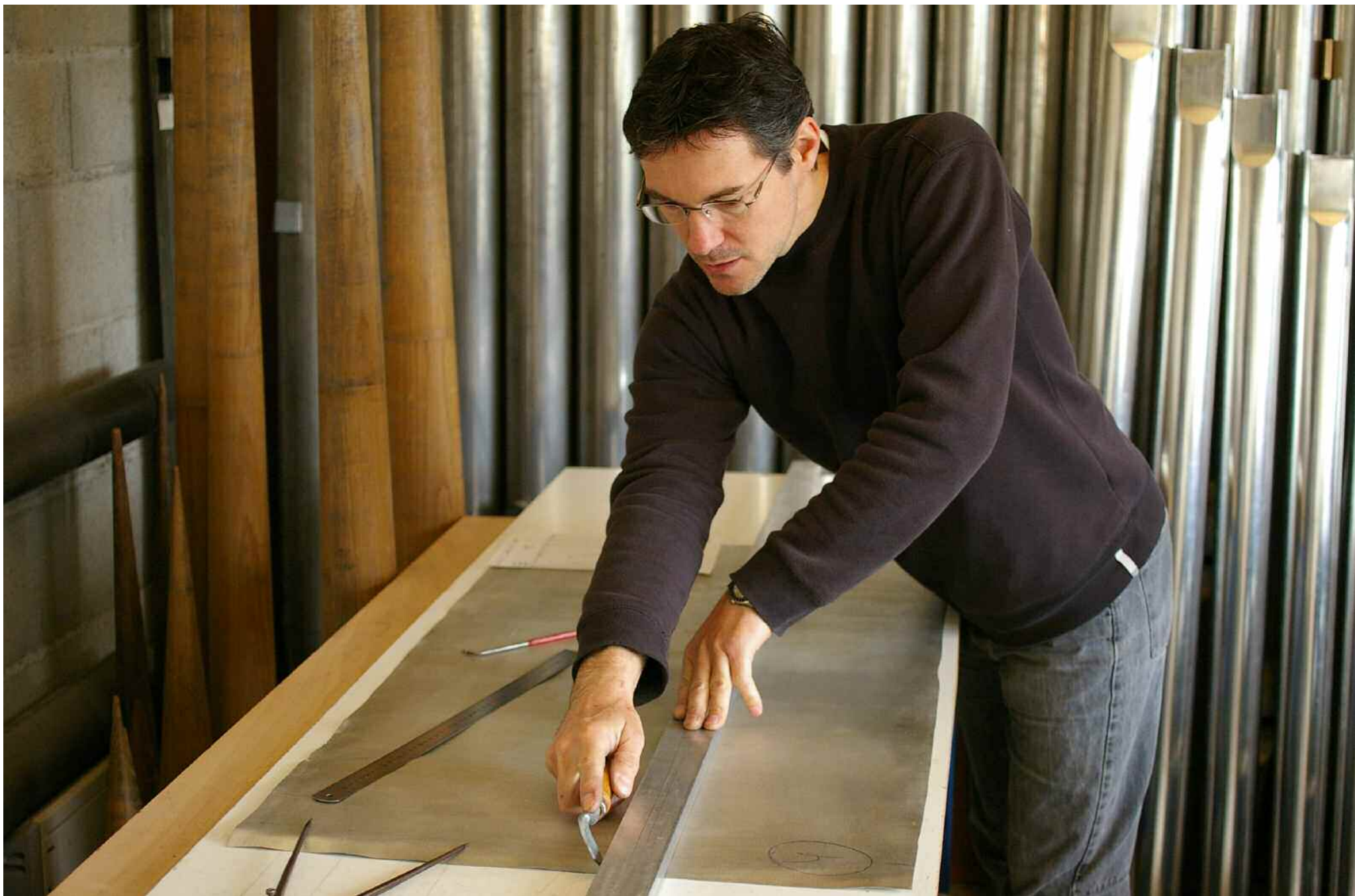
DÉCOUPE D'UNE FEUILLE POUR LE TUYAU
