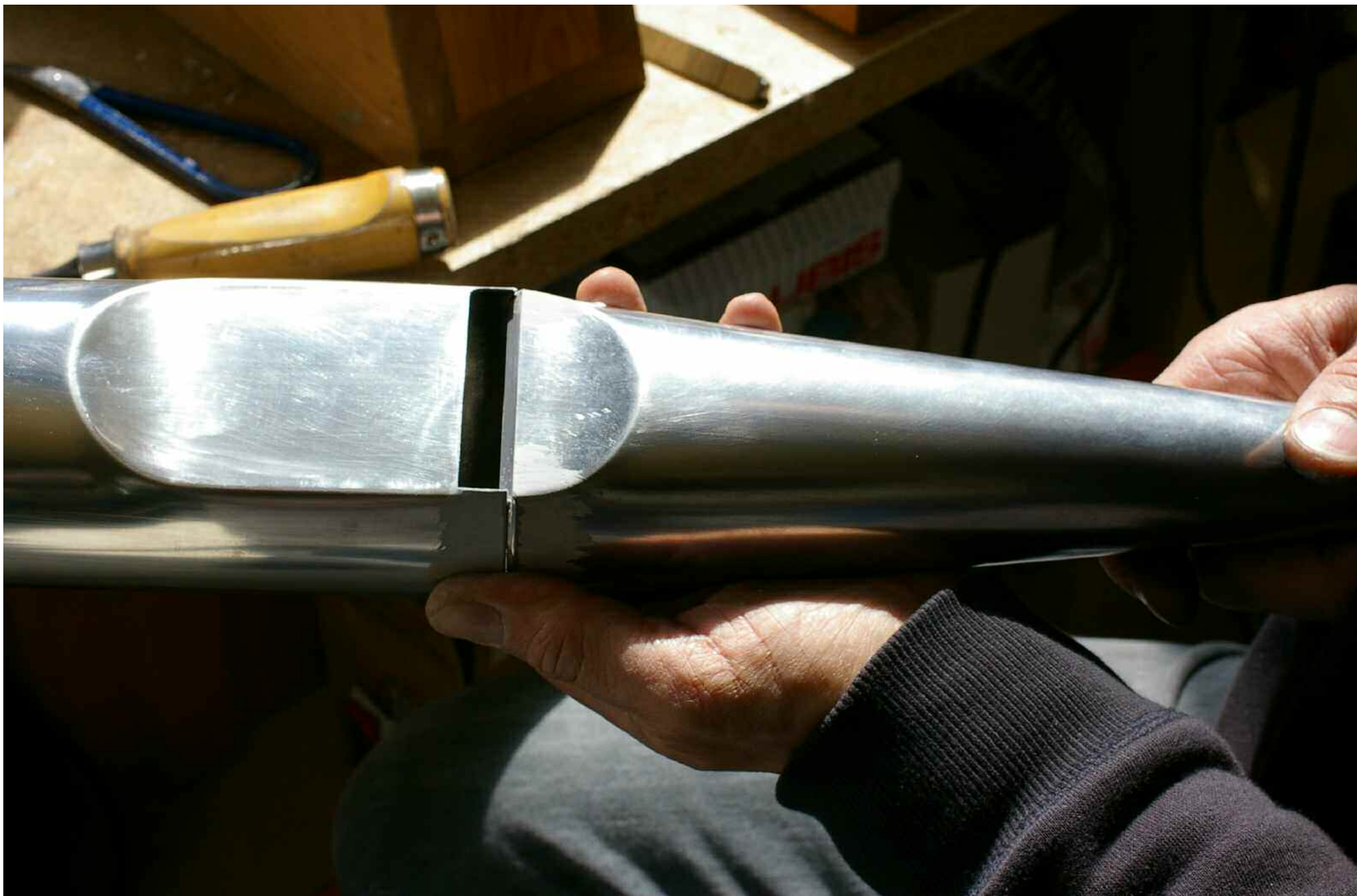
PRÉSENTATION DU PIED SUR LE CORPS AVANT SOUDURE
