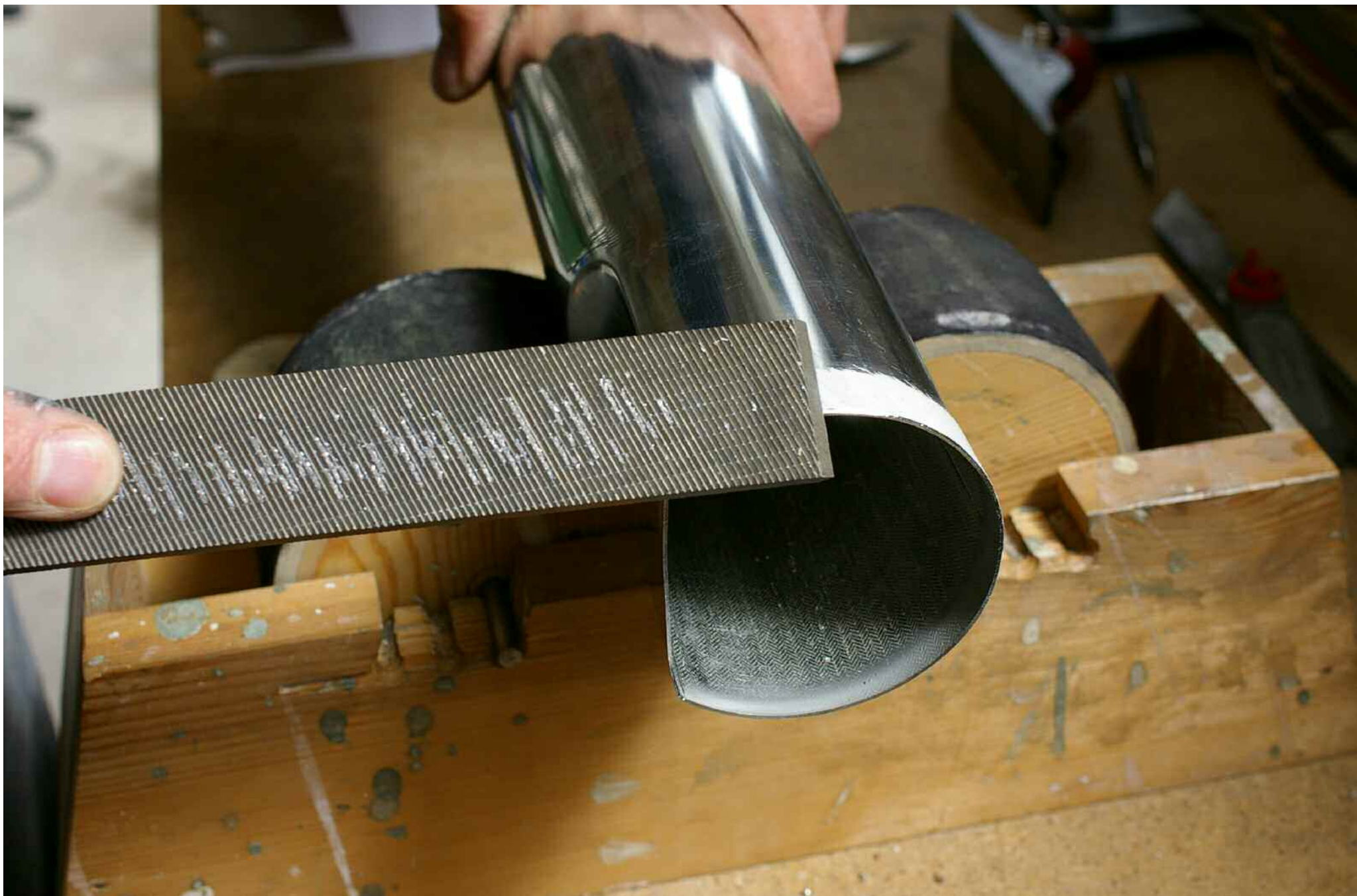
CHANFREINAGE DE PRÉPARATION À LA SOUDURE
